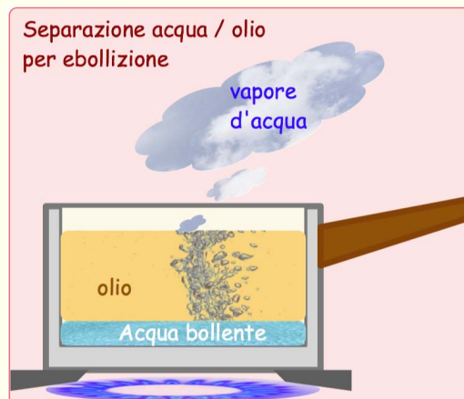
Separazione per ebollizione (finché non c'è più vapore)
