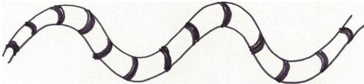
Inoltre hanno una struttura con anelli regolari. Essa serve a dare stabilità alla fibra quando si piega (si pensi al tubo dell'aspirapolvere).
